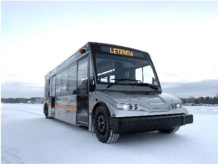
Letenda a choisi d'équiper ses bus électriques du système de batterie ZEN PLUS, une solution avancée de stockage d'énergie développée par Forsee Power. Le système appliqué à l'Electrip se compose de quatre packs ZEN 82 PLUS, offrant une capacité de 308 kWh qui permet jusqu'à 300 km (186 miles) d'autonomie. Les batteries légères de Forsee Power combiné au design d'Electrip dédié à la traction électrique en font un véhicule particulièrement performant.
