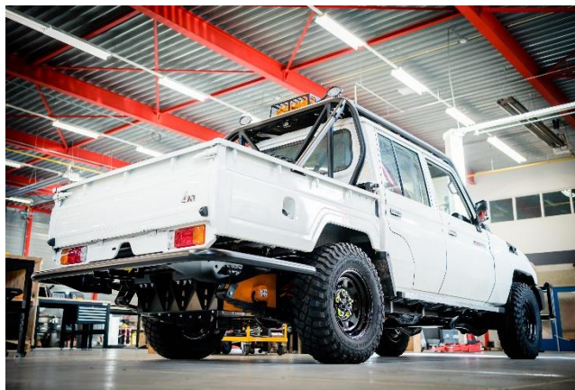
4 000 véhicules 4x4 seront convertis par Tembo en véhicules électriques en intégrant le système de batteries ZEN 8 SLIM.
