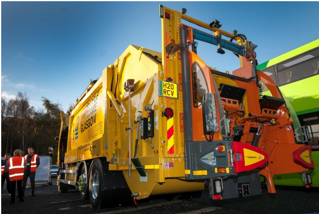
Le démonstrateur de véhicule de collecte des ordures ménagères à hydrogène développé par Ballard Motive Solutions
